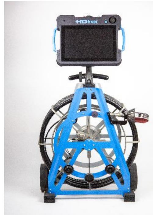
**Es wird zwei Kabeltrommeln** mit einer Kapazität von 150 und 300 Metern geben - Automatischer Motortrommel, Führungsrolle für Kabelentlastung, Sensor für abgewickelten Kabellänge, wasserfest gegen Wasserspritzen, max. Kapazität 150/300 m Kabel.
