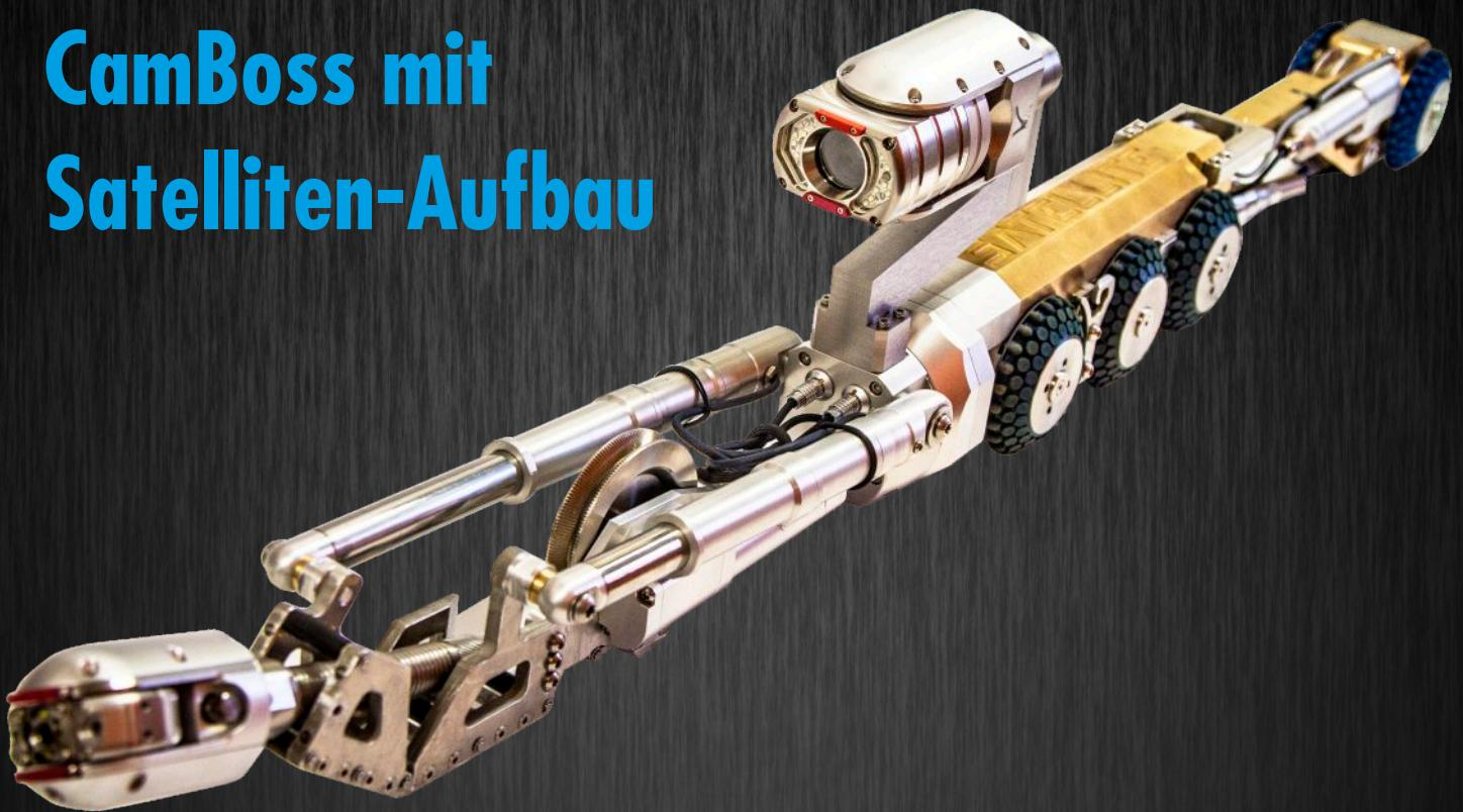
Erweiterung vom Kamerafahrwagen Boss 150 (6 x 6) um Satelliten-Anpassung für Rohrmonitoring DN 150 – 1000. Die Sichtkamera ist Bestandteil vom Satelliten-Aufbau, Monitoring von Rohranschlüsse ist seitens Schwenkkamerakopf KZ60 ermöglicht.
